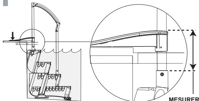
1) Lorsque l'escalier a été entièrement immergé, placer en position, avec les bras de support appuyés sur le deck.
