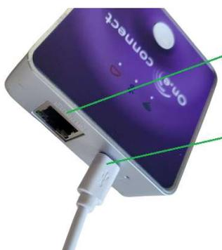
⑤ Prise de connexion Ethernet (RJ45)
