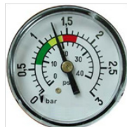
1,3 kg/cm 2 : La presión es 0,5 kg/cm 2 superior a la inicial, esto indica que es necesario proceder al LAVADO
