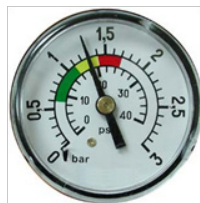
1,3 \text{kg/cm}^2 : Der Druck beträgt 0,5 \text{ kg/cm}^2 mehr als der Anfangsdruck. Das bedeutet, dass eine REINIGUNG notwendig ist
