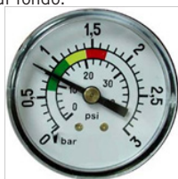
0,8 kg/cm 2 : Pressione iniziale di un filtro all'inizio di un ciclo di filtraggio
