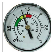
1,3 kg/cm 2 : La pression est 0,5 kg/cm 2 supérieure à la pression initiale, cela signifie qu'il faut procéder au LAVAGE
