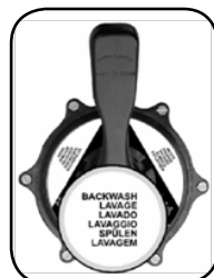
1,3 kg/cm 2 : La presión es 0,5 kg/cm 2 superior a la inicial, esto indica que es necesario proceder al LAVADO
