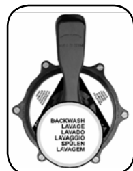
1,3 kg/cm 2 : La pression est 0,5 kg/cm 2 supérieure à la pression initiale, cela signifie qu'il faut procéder au LAVAGE
