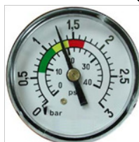
1,3 kg/cm 2 : La pressione è di 0,5 kg/cm 2 superiore a quella iniziale, ciò significa che è necessario procedere al LAVAGGIO
