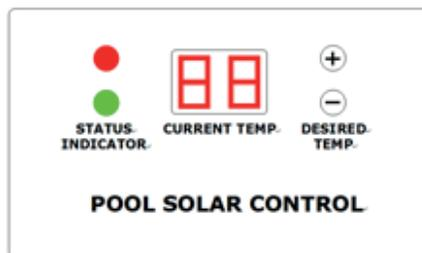
Aktuelle Temp: zeigt die aktuelle Temperatur des Wassers (im 3-Wege-Ventil integrierter Temperatursensor)
