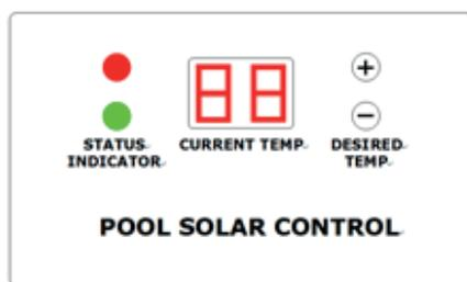
Aktuell temp.: Viser aktuell vanntemperatur (temperatursensoren er integret i treveisventilen)
