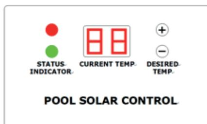
Nuvarande temperatur: visar aktuell temperatur i vattnet (en temperaturgivare är integrerad i 3-vägsventilen)
