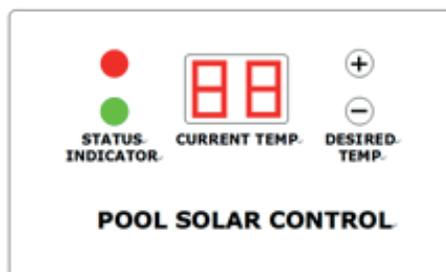
Bieżąca temperatura: pokazuje aktualną temperaturę wody (czujnik temperatury zintegrowany w zaworze trójdrożnym)
